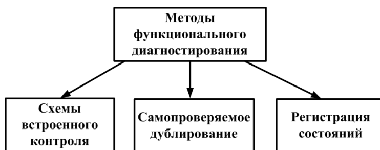
Рис. 1. Методы функционального диагностирования
