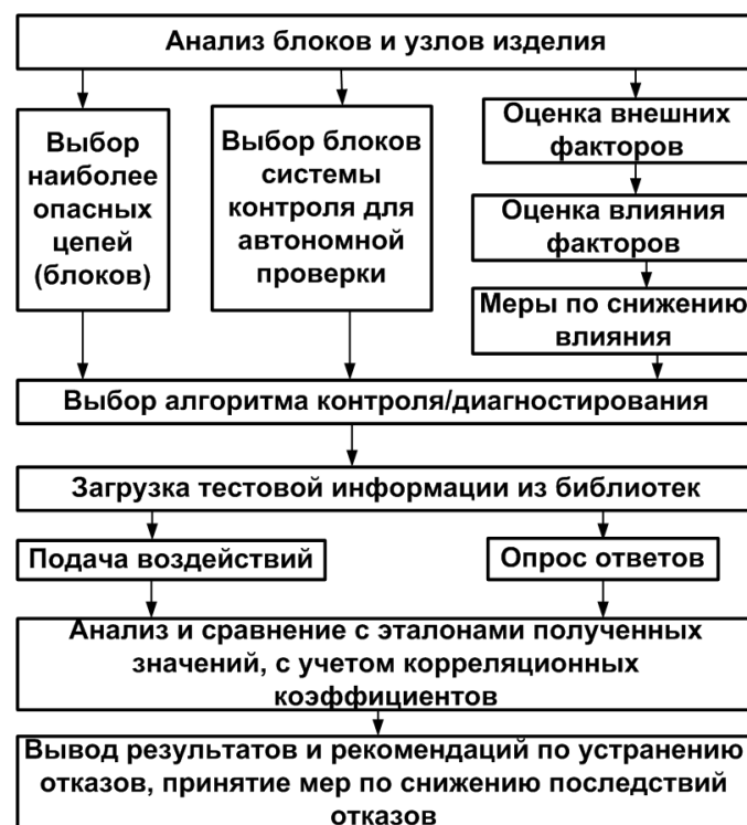
Рис. 3. Структура алгоритма автоматизации процесса диагностирования
